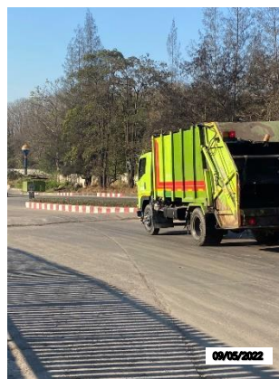
รูปที่ 2 - 72 รถขนส่งขยะชุมชนติดตั้งกล่องรับน้ำเสีย
